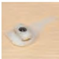
Bei Kälte zieht sich Aluminium stärker zusammen als Holz. Das sorgt für Spannung auf dem Rahmen. Dem beugen wir vor, indem wir die Aluschalen auf Gleitkupplungen – wie auf einem Schienensystem – lagern.
