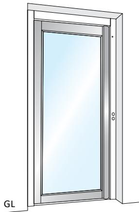
Einflügelige Aluminiumtür mit **manueller Öffnung und automatisches Schließen.**
