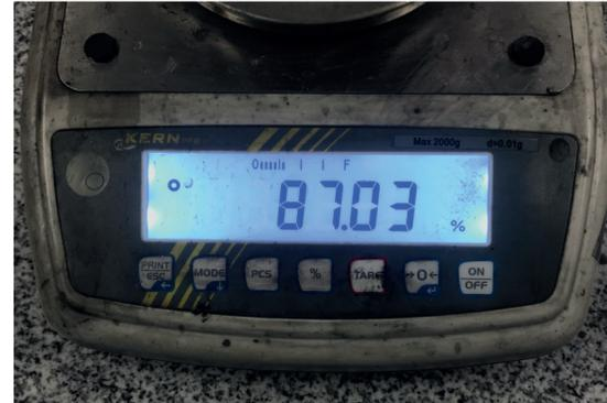
Die Laborwaage der ersten Stunde zeigt den direkten Vergleich: ca. 15% Gewichtsreduktion bei einem Standard-Bremsbelag mit identischem Stahl-Belagträger.
