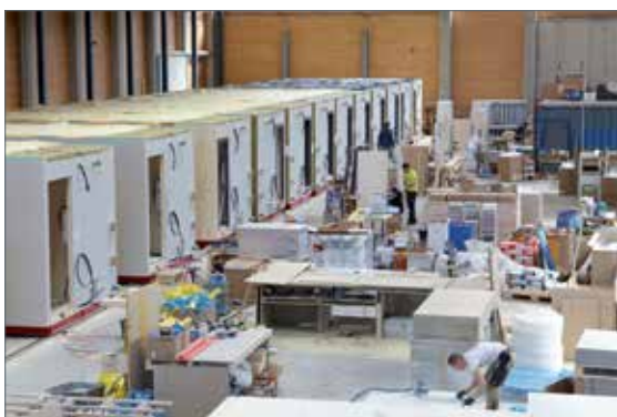
Das Holz für „Woodie“ stammt aus Österreich. Auch die Vorfertigung der Module fand hier statt
