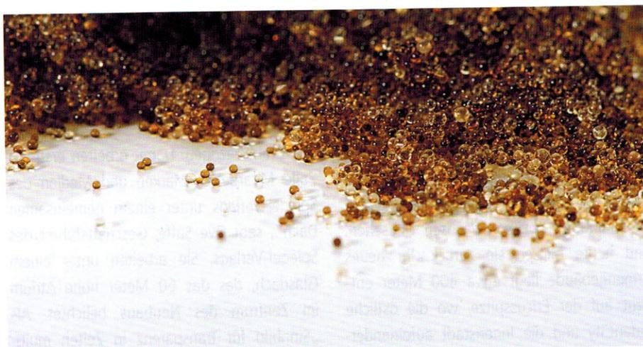
Wasser zur Reinigung von Solar- und PV-Anlagen lässt sich unterschiedlich aufbereiten: per Umkehrosmose oder per Ionenaustauscher-Verfahren. Ersteres bietet sich bei hohem Wasserbedarf an, sollte aber permanent eingesetzt werden. Letzteres setzt auf mit Ionenaustauscher-Harz gefüllte Patronen. An den Wasserhahn angeschlossen, produzieren sie vollentsalztes Wasser. Ist die Kapazität der Patrone erschöpft, kann sie neu befüllt werden.
